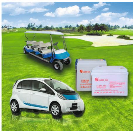
Аккумуляторные батареи Sacred Sun серии DM разработаны специально для крупных транспортных средств, таких как электрические трактора, машины для гольфа, экскурсионные автомобили и др. Серия состоит из 12В батарей ёмкостью от 70Ач до 165Ач, 6В от 185Ач до 285 Ач и 8В 170Ач. Температурный режим работы АКБ от -20°С до + 55°С.
